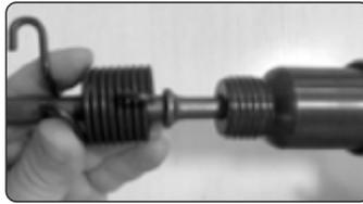
2 - Após ter inserido a ponteira na mola/retentor, encaixe a ponteira no martelo rebarbador.
