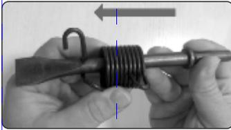
1 - Insira a ponteira por dentro da mola/retentor conforme imagem a seta mostrando a direção.
