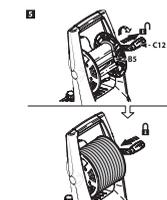
4. Encaixe a manivela (C12) ao eixo do carretel (B5). Para destravar o carretel puxe a manivela (C12) conforme a imagem. Após enrolar ou desenrolar a mangueira, trave o carretel empurrando a manivela conforme a imagem.
