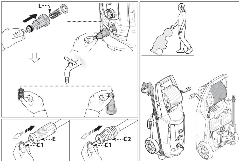
**10.** Periodicamente efetue a limpeza do filtro de entrada de água. Para isso, remova o adaptador na entrada de água, retire o filtro e lave-o com detergente neutro. Não utilize o equipamento com o filtro danificado ou sem o filtro pois pode danificar a bomba.
