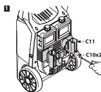
1. Com uma chave phillips (não fornecida) parafuse o suporte de acessórios C11 com 2 parafusos C10.
