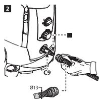
2. Conecte a mangueira de alimentação de água (diâmetro mínimo 1/2" ou 13mm) na torneira. Conecte a outra ponta da mangueira de alimentação ao equipamento na entrada de água. Utilize sempre o filtro de entrada de água C9 fornecido.
